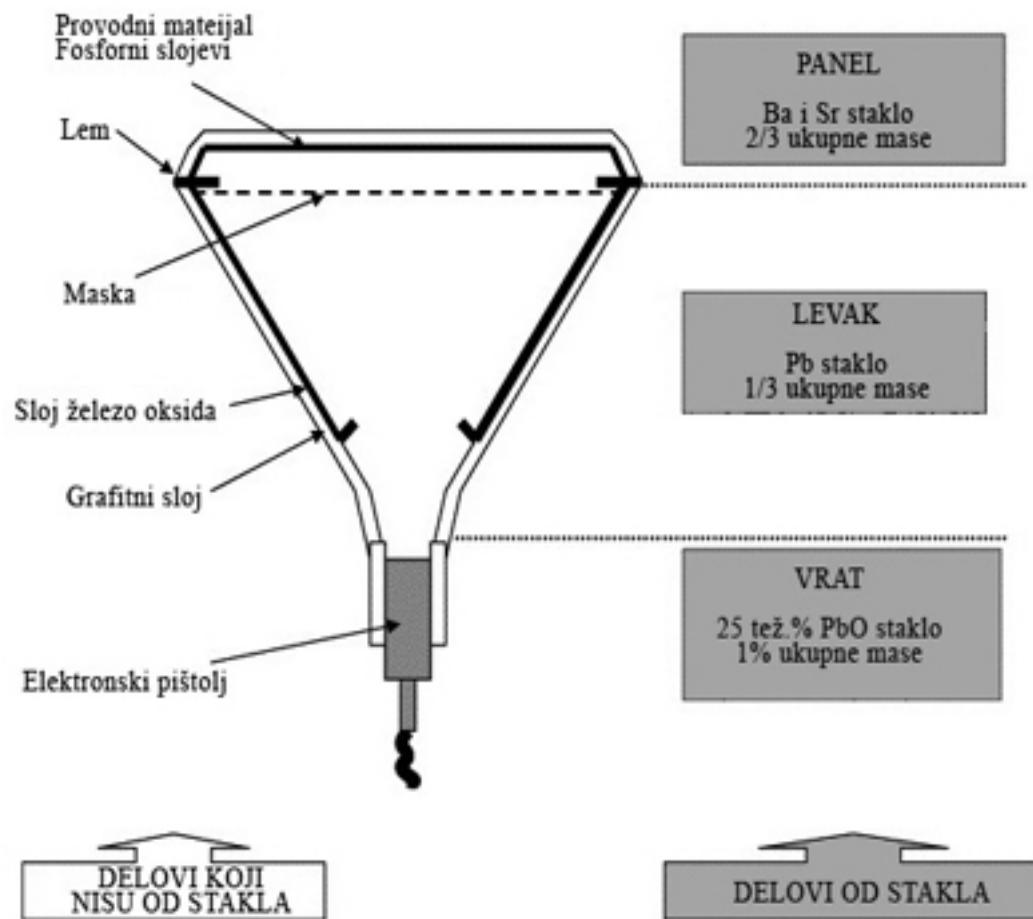
Spisak delova koji nisu od stakla je uključujući: Elektronski pištolj, Grafitni sloj, Sloj železo oksida, Maska, Lem, Provodni materijal i Fosforni slojevi.
